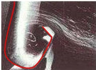
Gereduceerde vortices in een 'Modified Ristroph/Fletcher' design
