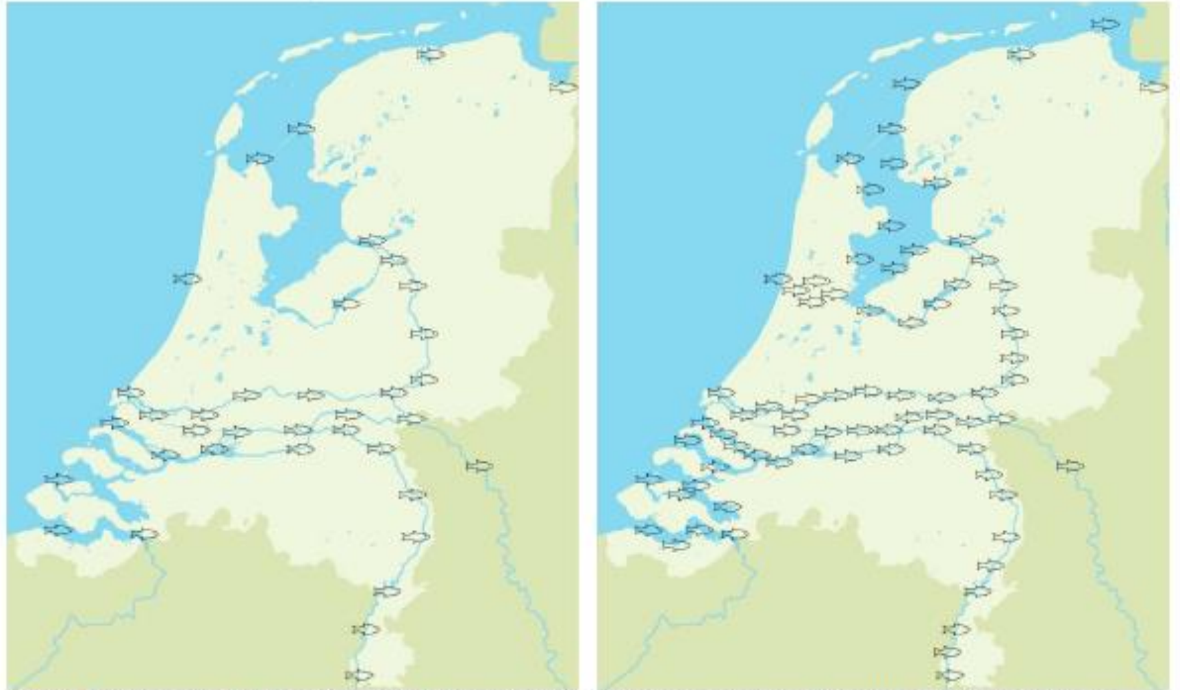
Figuur 6. Twee ambitieniveaus voor de inrichting van een permanent meetnetwerk met akoestische telemetrie. Links is een basisinrichting weergegeven met meetstations op intreklocaties, belangrijke routes en belangrijke vismigratieknelpunten. Rechts is een meer uitgebreide inrichting weergegeven met meetstations op locaties waar verbindingen tussen Rijkswateren en regionale wateren aanwezig zijn.
